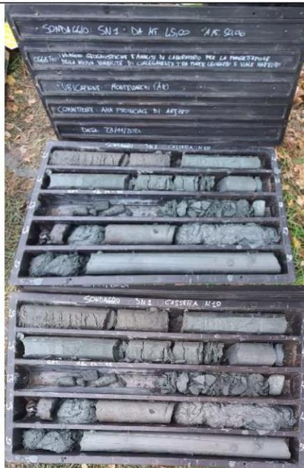
Nel foro di sondaggio SN1 sono state realizzate n° 14 prove SPT, le quali permettono una prima caratterizzazione geotecnica dei terreni; le correlazioni di Terzaghi & Peck permettono di ricavare, dall' $N_{SPT}$  l'angolo di attrito ed il modulo edometrico: si ricava, solo per le sabbie medie fino a sabbie ghiaiose – estendibili cautelativamente anche ai materiali lapidei, dalla formula di Shioi-Fukuni 1982:
